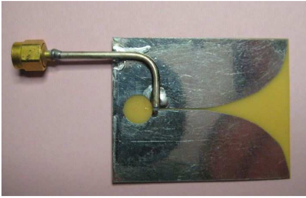
Antenne vivaldi commerciale fabriquée par WA5VJB et les cotes de l'antenne , PB FR4 0.4mm
